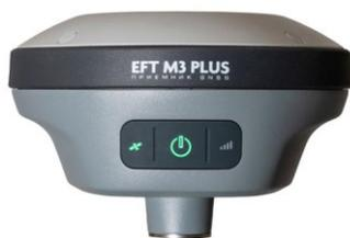
Рис.1. GNSS-приемник EFT M3 PLUS
